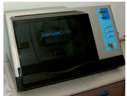
Vollautomatischer CAM (Computer Aided Manufacturing)-gesteuerter Zirkon-Fräsmaschine
